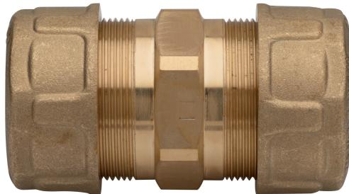
Raccordo a compressione doppio passante a innesto rapido con guarnizione in elastomero a sezione trapezoidale fino a PN50/MOP5.
