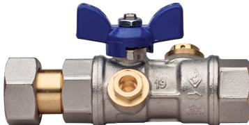
Valvola a sfera per acqua per uscita contatore, a passaggio totale, filettatura femmina/girello, ritegno maggiorato incorporato, farfalla in alluminio, prese pressione e sfera con sistema di risciacquo automatico.
