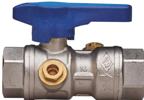
Valvola a sfera di uscita contatore acqua a passaggio totale, filettatura F/F, ritegno **maggiorato** incorporato, prese pressione, leva in tecnopoliomerio e sfera con sistema di risciacquo automatico.
