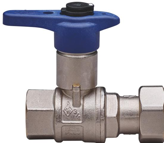
Valvola a sfera di entrata contatore acqua a passaggio totale, filettatura femmina/girello, leva in tecnopolimero, serratura di sicurezza e morosità estraibile e sostituibile e sfera con sistema di risciacquo automatico.
