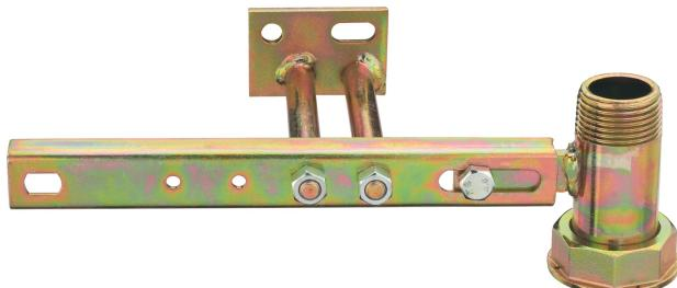
Traversa in acciaio, interasse 250 mm con canotto, filettatura EN 10226-1 e zanca a due colonne per tasselli ad espansione.
