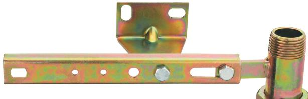
Traversa in acciaio, interasse 250 mm con canotto, filettatura EN 10226-1 e zanca triangolare per tasselli ad espansione.
