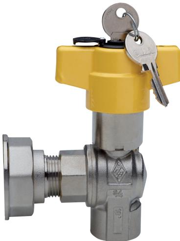
Valvola a sfera per gas a passaggio totale, a squadra, filettatura femmina, con raccordo per contatore gas, serratura di sicurezza e morosità estraibile e sostituibile.
