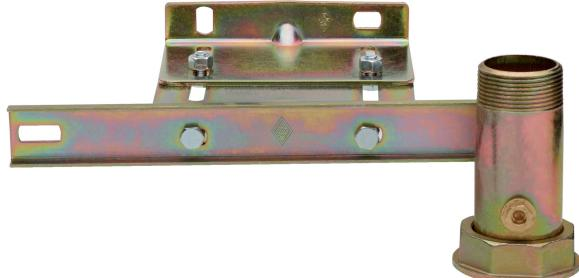
Traversa in acciaio, con canotto filettato UNI EN 10226-1 e presa pressione UNI ISO 228/1 G 1/4", zanca a muro regolabile per contatori G10-G16.
