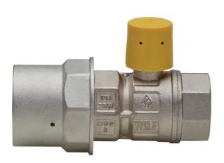
Valvola a sfera per colonna montante gas, con cappuccio piombabile, passaggio ridotto filettatura femmina ed attacco PE, raccordo per tubo di protezione in acciaio.
