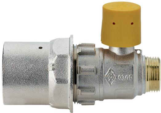
Valvola a sfera per colonna montante gas, con cappuccio piombabile, a passaggio totale, filettatura maschio sfero-conico ed attacco PE, raccordo per tubo di protezione in acciaio.
