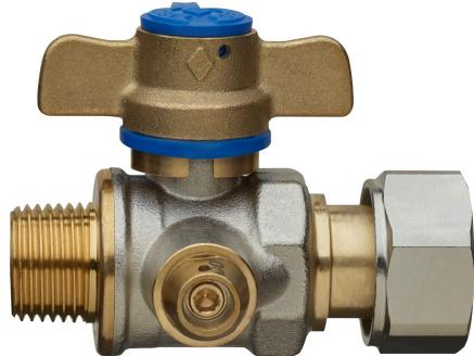
Valvola a sfera, ingresso contatore, a passaggio totale, attacchi maschio/girello, unidirezionale, farfalla **antimanomissione** e **dado di sicurezza in acciaio inox**, dotata di dispositivo di minimo vitale e sfera con sistema di risciacquo automatico.
