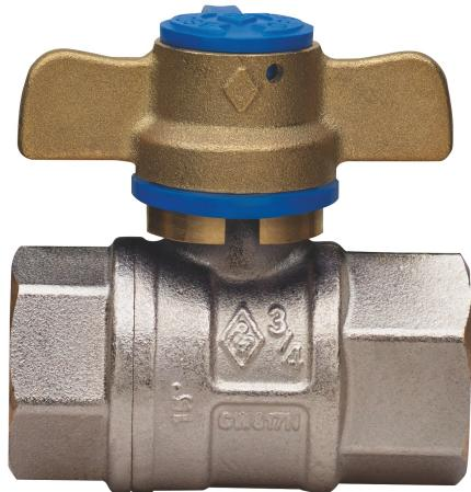
Valvola a sfera per acqua per ingresso contatore, a passaggio totale, filettatura F/F, con farfalla **antimanomissione** e **dado di sicurezza in acciaio inox a profilo eptagonale**, sfera con sistema di risciacquo automatico.
