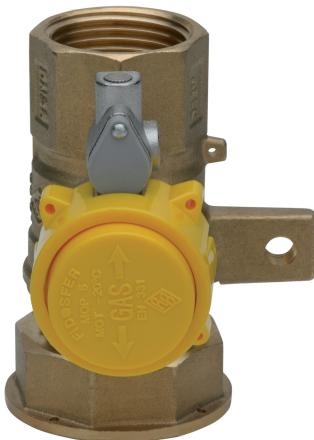
Valvola a sfera per contatore gas, con attacco per ferro mensola, blocco di sicurezza e cappuccio di protezione.
