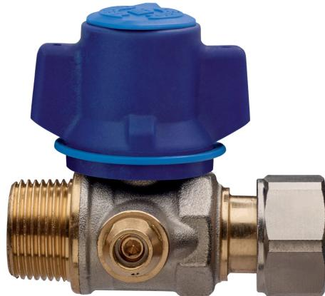
Valvola a sfera, ingresso contatore, a passaggio totale, attacchi maschio/girello, unidirezionale, farfalla **antimanomissione** e **dado di sicurezza in acciaio inox**, dotata di dispositivo di minimo vitale e sfera con sistema di risciacquo automatico.
