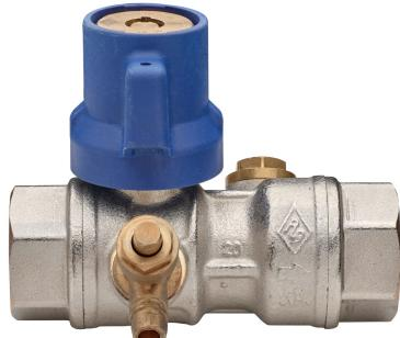
Valvola a sfera di uscita contatore acqua a passaggio totale, filettatura F/F, ritegno maggiorato incorporato, presa pressione e rubinetto di spurgo, sfera con sistema di risciacquo automatico e sistema di minimo vitale installato.
