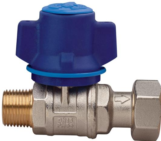
Valvola a sfera per acqua per ingresso contatore, a passaggio totale, filettatura maschio/girello, ritegno incorporato, con farfalla antimomanomissione e **dado di sicurezza in acciaio inox a profilo eptagonale**, sfera con sistema di risciacquo automatico.
