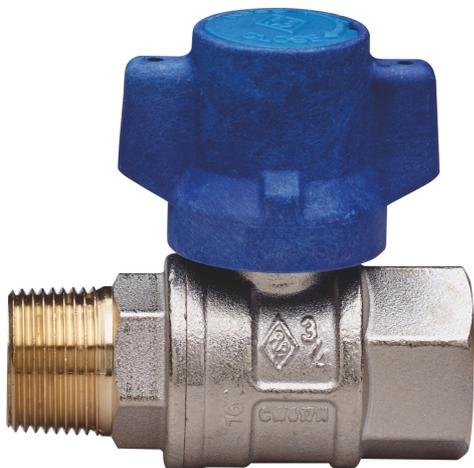
Valvola a sfera per acqua per ingresso contatore, a passaggio totale, filettatura M/F, con farfalla antimanomissione e **dado di sicurezza in acciaio inox a profilo eptagonale**, sfera con sistema di risciacquo automatico.
