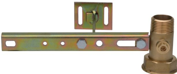
Traversa in acciaio interasse 250 mm, con canotto in ottone e presa pressione filettatura EN 10226-1, zanca h.115 per tasselli ad espansione.
