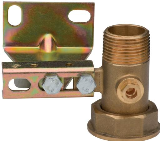
Traversa in acciaio, interasse 110 mm con canotto in ottone e presa pressione, filettatura EN 10226-1, zanca triangolare per tasselli ad espansione.
