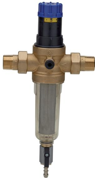
Réducteur et stabilisateur de pression avec siège compensé avec écrou et raccord, réglage de 1,5 à 6 bar, système de filtration 100 microns amont du flux.
