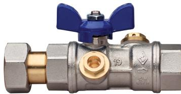
Vanne à boisseau sphérique de sortie compteur de l'eau à passage total, taraudée femelle/écrou, grand anti-retour incorporé, raccord pression, poignée papillon en aluminium et sphère avec système automatique de rinçage.
