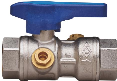
Vanne à boisseau sphérique de sortie compteur de l'eau à passage total, taraudée F/F, **grand** anti retour incorporé, raccord pression, poignée en Tecnopolymère et sphère avec système automatique de rinçage.
