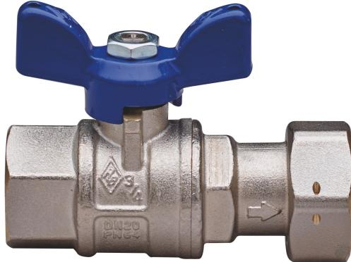
Vanne à boisseau sphérique d'entrée compteur de l'eau, passage total, taraudées femelle/raccord, poignée papillon en aluminium et sphère avec système automatique de rinçage.
