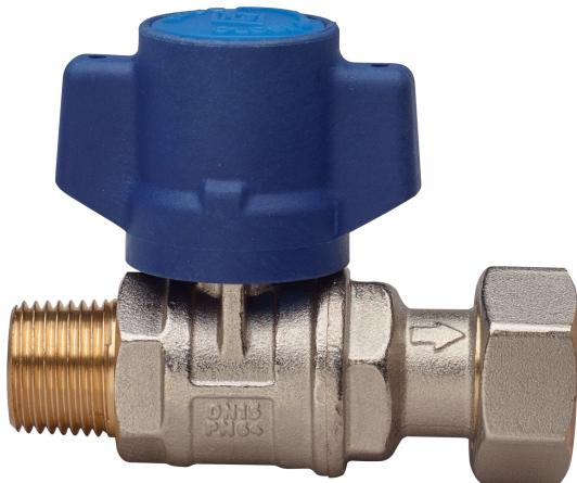
Vanne à boisseau sphérique d'entrée compteur de l'eau, à passage total, taraudée M/écrou, anti-retour incorporé, avec poignée anti-violation et sphère avec système de rinçage automatique.
