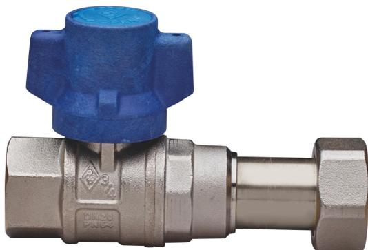
Robinet à boisseau sphérique d'entrée compteur de l'eau à passage totale, taraudée femelle/raccord télescopique, avec papillon **anti-violation** et sphère avec système automatique de rinçage.
