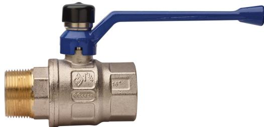
Vanne à boisseau sphérique d'entrée compteur d'eau, à passage total, taraudée M/F, avec poignée en aluminium, bloc anti-violation et sphère avec système de rinçage automatique.
