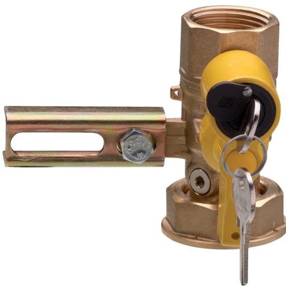
Vanne à boisseau sphérique passage intégral, après-compteur, écrou pour connexion directe, prise de pression, sortie femelle et verrou de sécurité.
