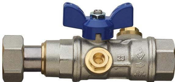
Vanne à boisseau sphérique de sortie de compteur d'eau à passage intégral, filetage femelle/raccord télescopique, clapet **majoré** incorporé, prises de pression, papillon en aluminium et sphère avec système de rinçage automatique.
