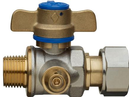
Vanne à boisseau sphérique d'entrée compteur de l'eau, à passage total, extrémité male/écrou, unidirectionnelle, poignée **inviolable** et écrou de sécurité en acier **inox**, avec dispositif de minimum vital et sphère avec système de système de rinçage automatique.
