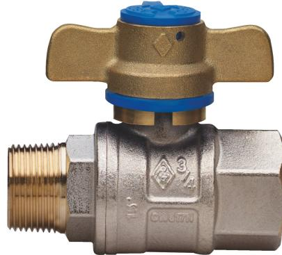
Vanne à boisseau sphérique pour l'entrée compteur d'eau, à passage total, taraudée M/F, avec poignée **anti-violation** et **écrou de sécurité en acier inox**, sphère avec système de rinçage automatique.
