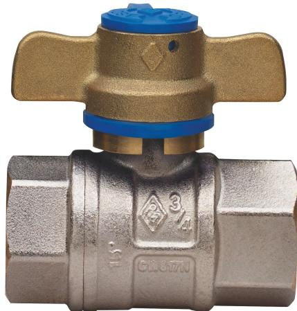
Vanne à boisseau sphérique pour l'entrée compteur d'eau, à passage total, taraudée F/F, avec poignée **anti-violation** et **écrou de sécurité en acier inox**, sphère avec système de rinçage automatique.
