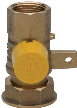
Robinet à boisseau sphérique pour compteur à gaz, avec connexion pour console en fer, avec capuchon jaune plombable.
