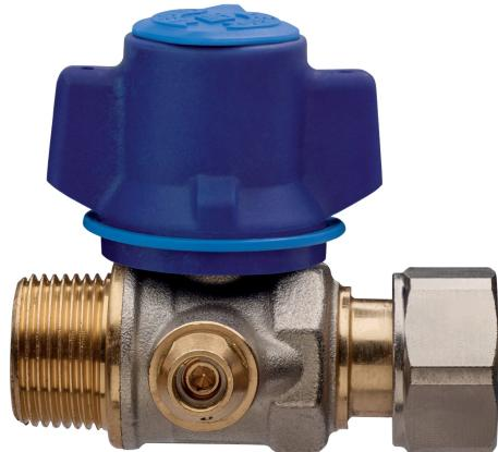
Vanne à boisseau sphérique d'entrée compteur de l'eau, à passage total, extrémité male/écrou, unidirectionnelle, poignée **inviolable** et **écrou de sécurité en acier inox**, avec dispositif de minimum vital et sphère avec système de rinçage automatique.
