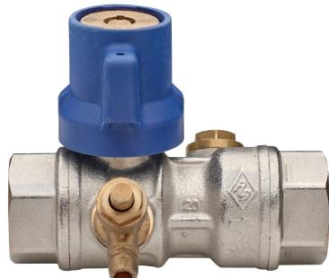
Vanne à boisseau sphérique de sortie compteur de l'eau à passage total, taraudée F/F, grand anti-retour incorporé, raccord pression et robinet de purge, avec dispositif de minimum vital et sphère avec système automatique de rinçage.
