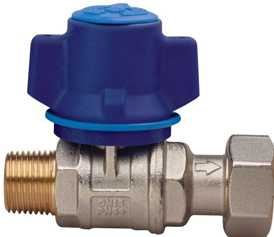
Vanne à boisseau sphérique entrée compteur de l'eau à passage total filetage M/écrou, maintien incorporé, avec poignée inviolable et **écrou de sécurité en acier inox à profil heptagonal**, sphère avec système de rinçage automatique.
