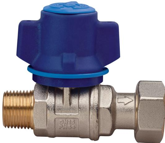
Vanne à boisseau sphérique d'entrée compteur de l'eau, à passage total, taraudée M/écrou, avec poignée **anti-violation** et **écrou de sécurité en acier inox**, sphère avec système de rinçage automatique.
