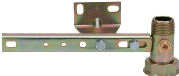
Traverse en acier, entre-axes 250 mm, avec raccord en laiton et prise de pression, taraudée EN 10226-1, avec support triangulaire pour vis murale.
