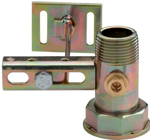
Traverse en acier, entre-axes 110 mm, avec raccord et prise de pression, taraudée EN 10226-1, avec support pour vis murale h.115.
