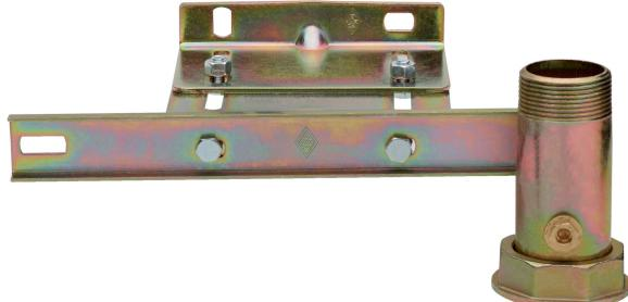
Traversa en acero, con anillo roscado UNI EN 10226-1 y conexión presión UNI ISO 228/1 G 1/4", soporte ajustable para medidor G10-G16.
