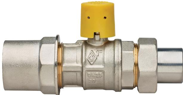
Válvula esfera para columna alimentación gas, con capuchos cerrables a paso total, conexión PE con rácor para el tubo de protección de hierro y conexión para soldar.
