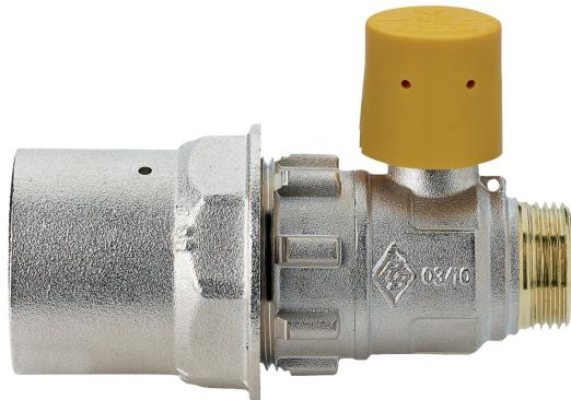
Válvula esfera para columna d'alimentacion gas, con capUCHO cerrable a paso total, rosca macho esfero cónico y conexión PE, racor por el tubo de protección de hierro.
