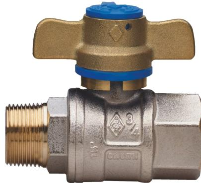
Válvula de bola para agua para entrada de medidor, paso completo, rosca M/F, con mariposa **a prueba de manipulaciones** y tuerca de seguridad en acero inox con perfil heptagonal, bola con sistema de enjuague automático.
