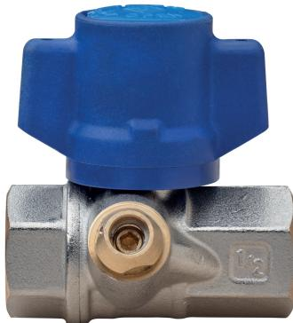
Válvula de bola para agua, entrada de contador, paso total, conexiones H/H, unidireccional, con mariposa a prueba de manipulaciones y **tuerca de seguridad en acero inoxidable con perfil heptagonal, equipada con dispositivo de mínimo vital** y esfera dotada de sistema de vaciado automático.
