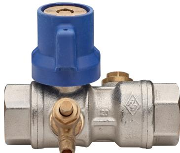
Válvula esfera de salida medidor agua a paso total, rosca hembra/hembra, retención grande incorporada, conexión presión et grifo de espurgación, mínimo vital y esfera con sistema de aclarado automático.
