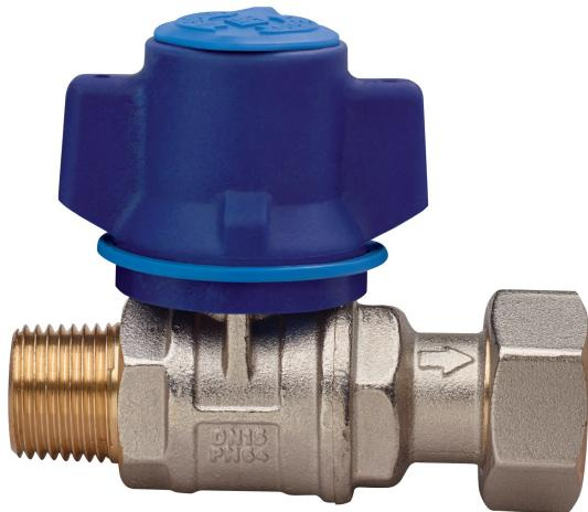
Válvula esfera a paso total para medidor de agua, rosca macho/arandela, retención incorporada, palanca anti-manipulación y **tuerca de seguridad de acero inoxidable**, bola con sistema de autolimpieza.
