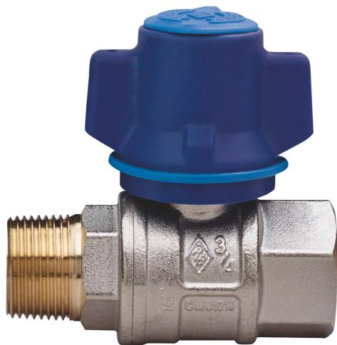
Válvula de bola para agua para entrada de medidor, paso completo, rosca M / F, con mariposa a prueba de manipulaciones y **tuerca de seguridad en acero inox con perfil heptagonal**, bola con sistema de enjuague automático.
