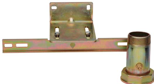
Traversa en acero, con anillo roscado UNI EN 10226-1 y conexión presión UNI ISO 228/1 G 1/4", para medidor G10-G16-G25.
