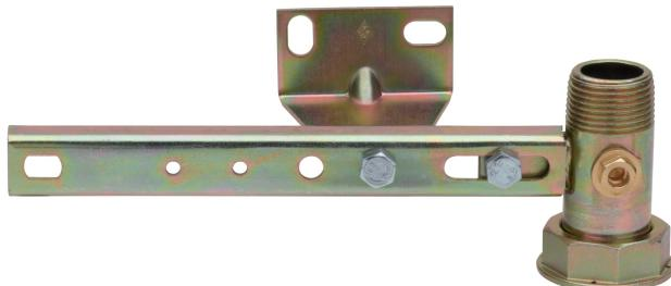
Traversa en acero, distancia 250 mm con anillo roscado y conexión presión/rosca EN 10226-1 y soporte triangular con juegos d'expansion.
