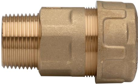
Schnellanschluss Klemmverschraubung AG mit Elastomerdichtung mit trapezförmigem Querschnitt bis PN50/MOP5.
