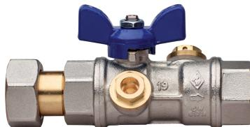
Kugelhahn für Wasserzähleranschluss, mit vollem Durchgang, Innengewinde/Gewindeverschraubung, mit eingebautem Rückschlagventil, mit manipulationssicherem Flügelgriff und Edelstahl Sicherheitsmutter, Kugel mit automatischem Spülsystem.
